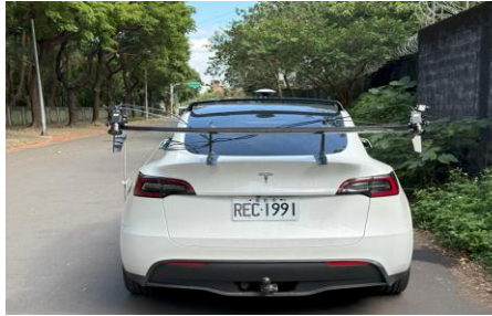
圖 23：人工智慧跨域科技研究所學生獲選參加 114 年度市區道路養護管理及人行環境無障礙績優縣市經驗交流研討會公開展示最新一代的鋪面平整度指標與損傷檢測系統
